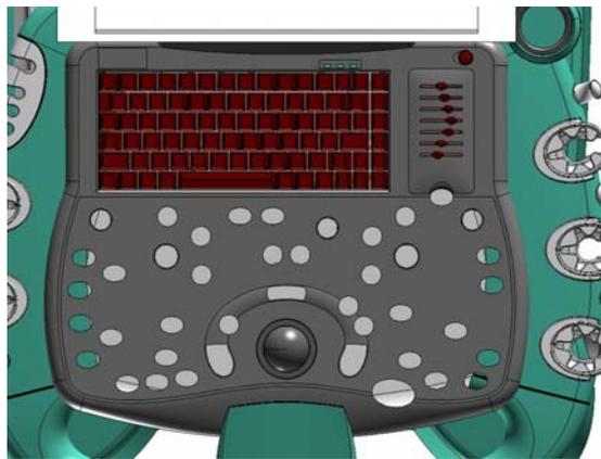
El panel incluye una sección alfanumérica (teclado, TGC y tecla ON/OFF), el trackball, una sección teclas software, y una Sección Controles.
