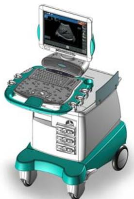
El sistema se compone de un panel de control, completo de monitor o LCD, y de una consola que lleva la electrónica y los conectores.
