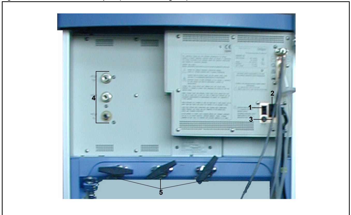
Figura 173. Parte trasera de la máquina (suministro de 3 gases)
