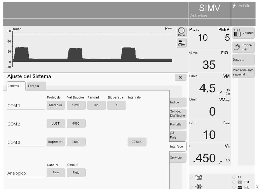
Para la conexión COM 1, COM 2 ó COM 3, en el campo Protocolo:
